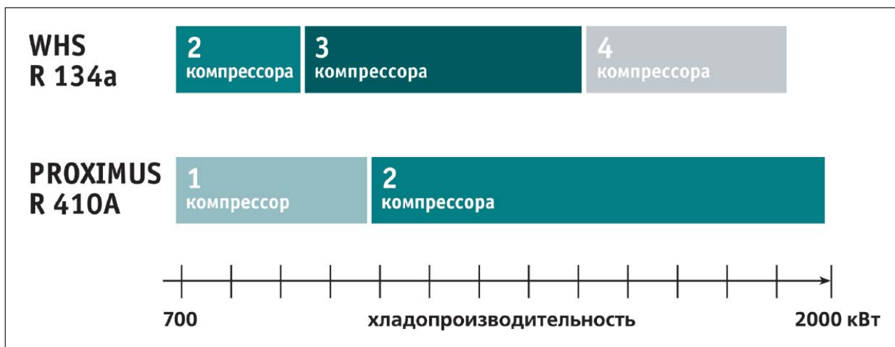
Рис. 2. Сравнительная диаграмма количества компрессоров в зависимости от производительности чиллера - для агрегатов WHS (хладагент R 134a) и PROXIMUS (хладагент R 410A)
