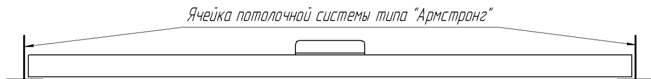
Рис. 3. Установка электрообогревателя в подвесной потолок типа «Армстронг».
